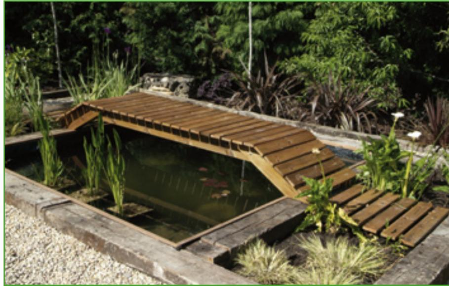
Para construir el puente vamos a emplear unos listones de madera de pino hidrófugo, muy apropiados para este tipo de trabajo y unos tornillos de cabeza de lenteja zincadas para fijar las traviesas a la estructura. Aplicaremos un barniz tinte de poliuretano, en nuestro caso de color teca, con el que conseguiremos un excelente acabado y para terminar, fijaremos la estructura al suelo con unas escuadras.
